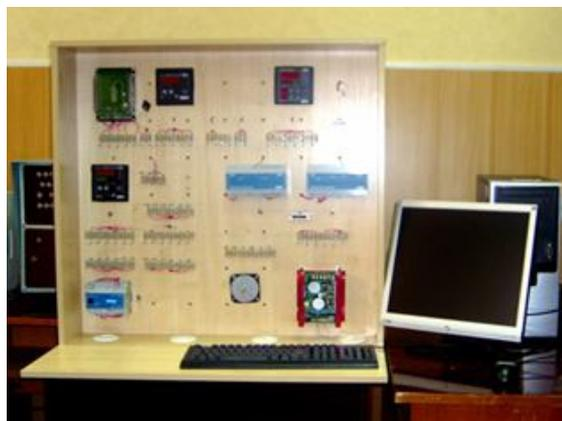
Рисунок 1 – Стенд для выполнения курсовых работ по измерительным информационным системам
